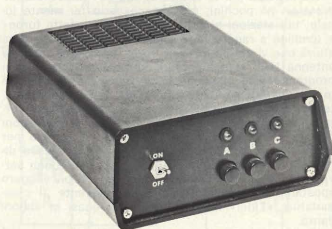
Vista esterna del gruppo alimentatore (per interni). Si notano i 3 tasti selettori sovrastati dai relativi LED. A sinistra l'interruttore generale.
