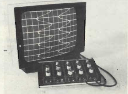
TV scope: una scheda che consente di ottenere un oscilloscopio a 100 kHz con un normale televisore
