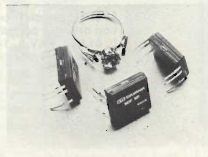
Filtri di media frequenza ad onda acustica di superficie per l'utilizzo nei televisori.
