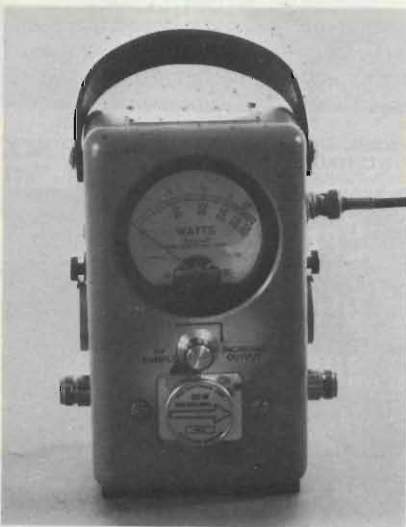
Wattmetro bidirezionale con uscita RF campionata di livello variabile.
